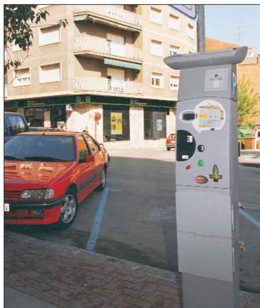
Els nous dispensadors funcionen amb energia solar. Permeten una millor ubicació i l'estalvi d'energia elèctrica.
